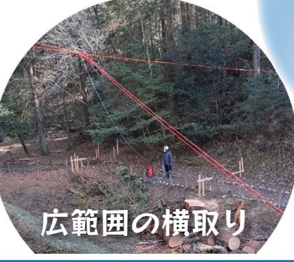
例) 広い傾斜地/法面の整備 保護木を回避しつつ切株を越えて広く集めることが可能
